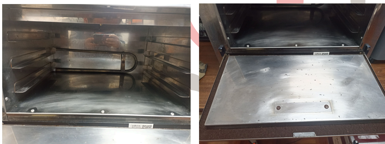
Fig. 4 Vista Libre de Corrosión Interna
