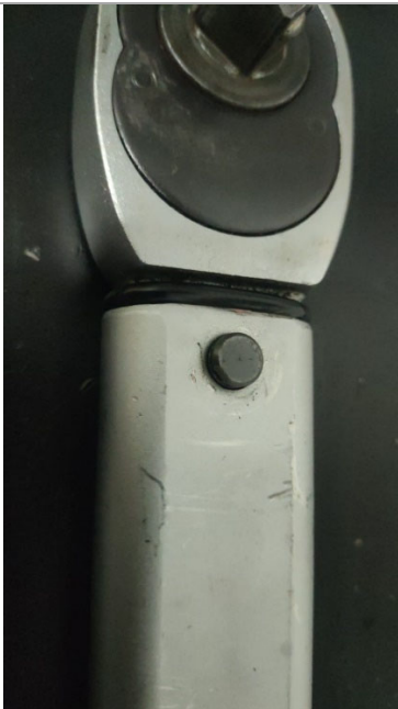
Falta el clic de seguridad de perno.
