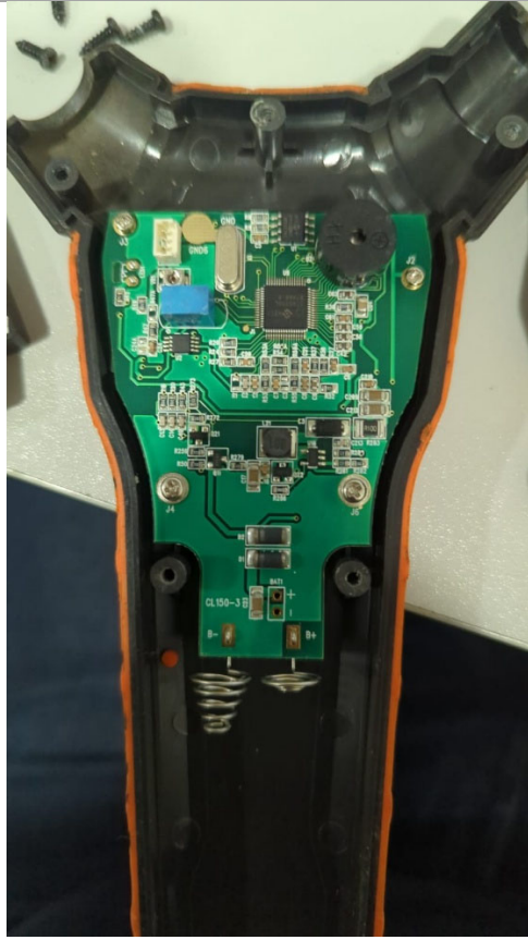
Fig 1 Revisión de placa, no se evidencia corrosión alguna
