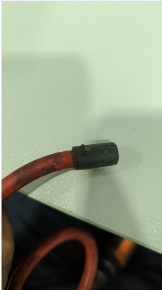
Fig 2. Posible Punto de quiebre del elemento captor de corriente
