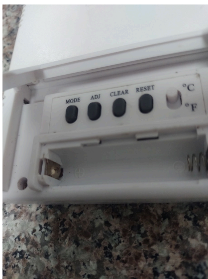
Figura 1. Presencia de óxido y residuos en el equipo
