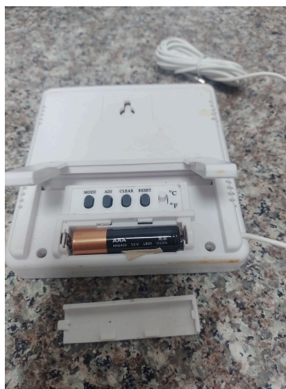
Figura 1. Presencia de óxido y residuos en el equipo
