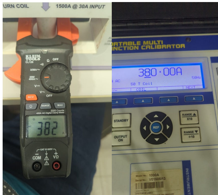
Fig 4 Prueba medición de corriente rango 400AAC @ 380AAC
