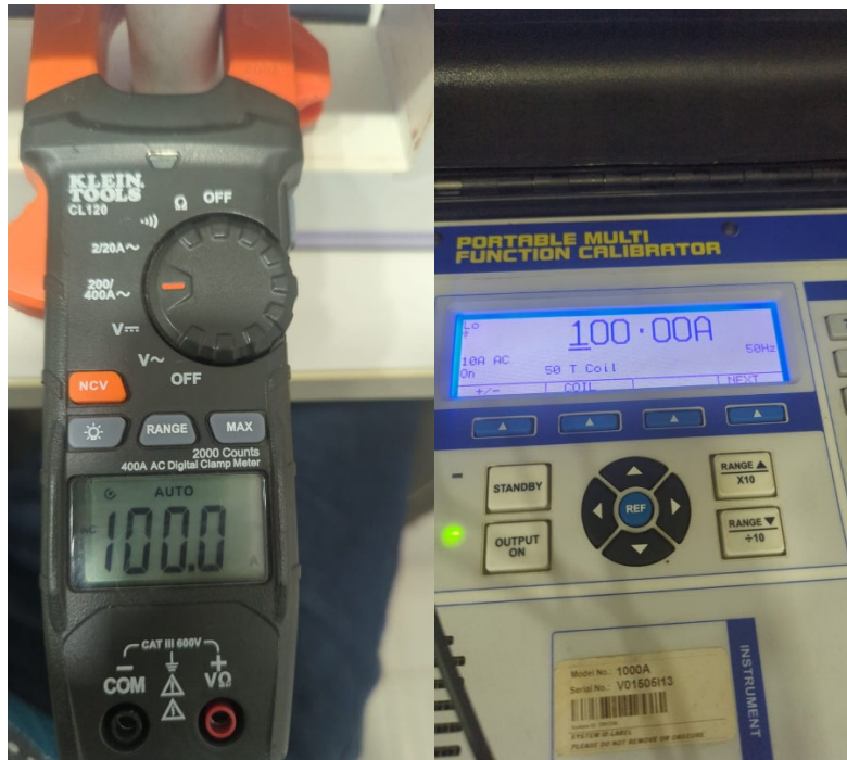
Fig. 3 Prueba medición de corriente Rango 400AAC @100AAC
