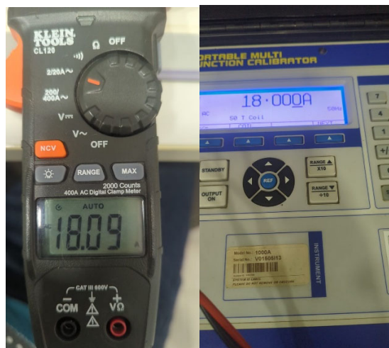
Fig 2. Prueba medición de corriente, rango 20AAC @18AAC
