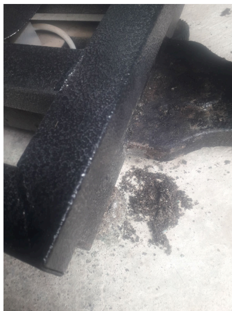
Presencia de bastante suciedad y polvo bajo el plato de la Balanza
